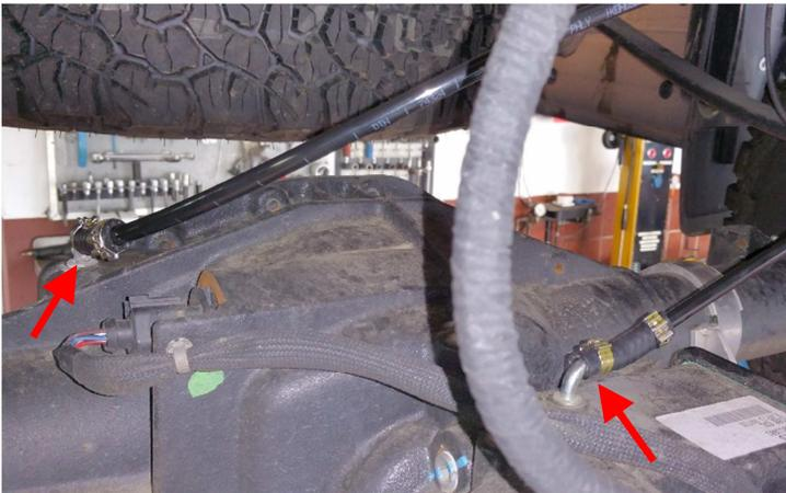
Legen sie jeweils eine der mitgelieferten kleinen (13,5-15 mm) Schlauchschellen über das Ende der mitgelieferten Leitung mit dem kurzen Verbindungsschlauch. Verbinden sie jeweils den kurzen Verbindungsschlauch mit dem Entlüftungsnippel für das Differential der Hinterachse und dem Entlüftungsnippel der Haldexkupplung.
