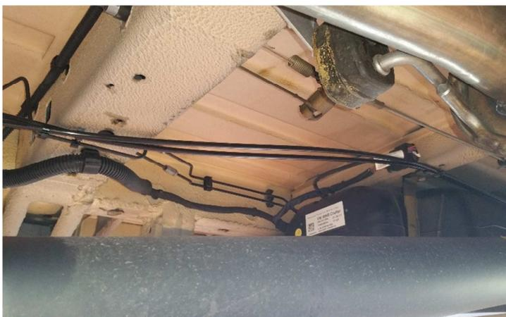
Verlegen sie die zwei Leitungen zwischen Tank und Kardanwelle weiter nach vorne.
