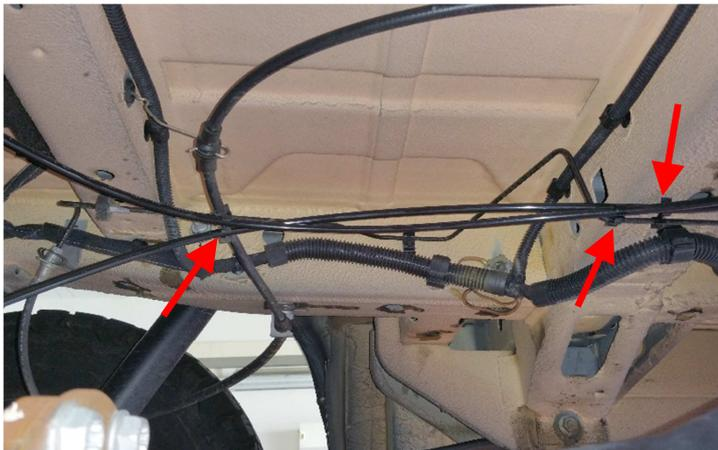
Verlegen sie die beiden Schläuche am Unterboden in Fahrzeugrichtung nach vorne. Verwenden sie zur Befestigung die Klipse an dem linken Handbremsseil von den originalen Entlüftungsleitungen. Die jeweils vormontierten Klipse an den Mitgelieferten Entlüftungsleitungen befestigen sie an der Bremsleitung die unter dem Querrahmen entlang zum linken Hinterrad geht.
