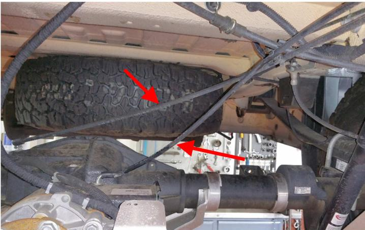
Entfernen sie die beiden originalen Entlüftungsschläuche an der Hinterachse.
