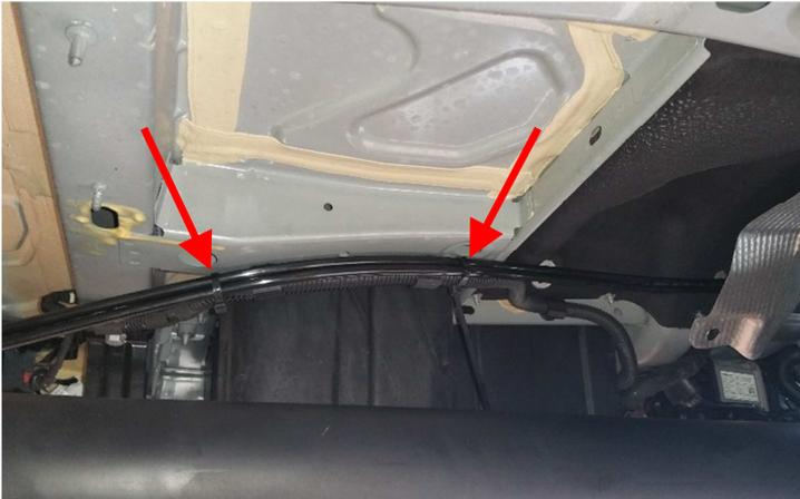
Befestigung der Leitungen mit Kabelbindern am Kabelbaum.
