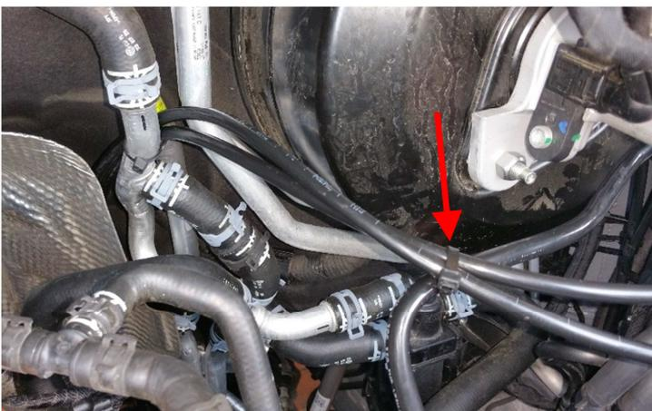
Verlegen sie die Leitungen hinter dem Hitzeschutzblech nach oben in den Motorraum am Bremskraftverstärker vorbei zum Halter mit den Filtern. Befestigen sie die Leitungen mit einem Kabelbinder an der Unterdruckleitung, die vor dem Bremskraftverstärker vorbeiführt.
