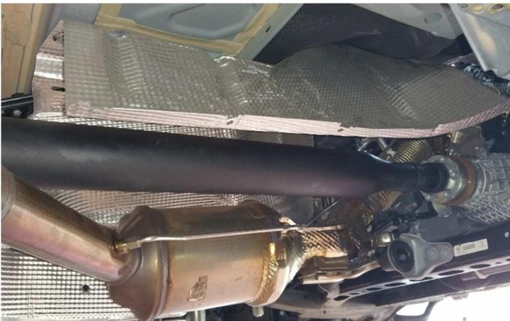
Bauen sie den Hitzeschutz im Bereich der Kardanwelle und des Katalysators wieder ein.
