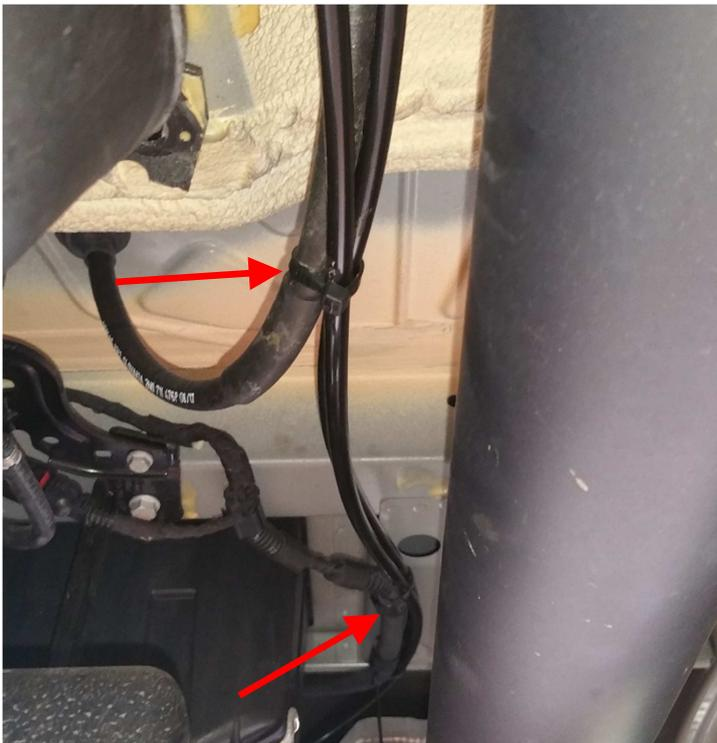
Befestigen sie die Leitungen mit Kabelbindern am Handbremsseil und dem Kabelbaum, der im Bereich des AdBlue-Tanks am Unterboden entlangführt.
