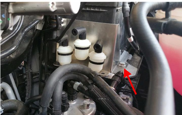
Bauen sie den mitgelieferten Halter für die Getriebeentlüftung über dem Halter für die Batterie ein und befestigen sie ihn mit der zuvor entfernten Schraube des Batteriehalters.
